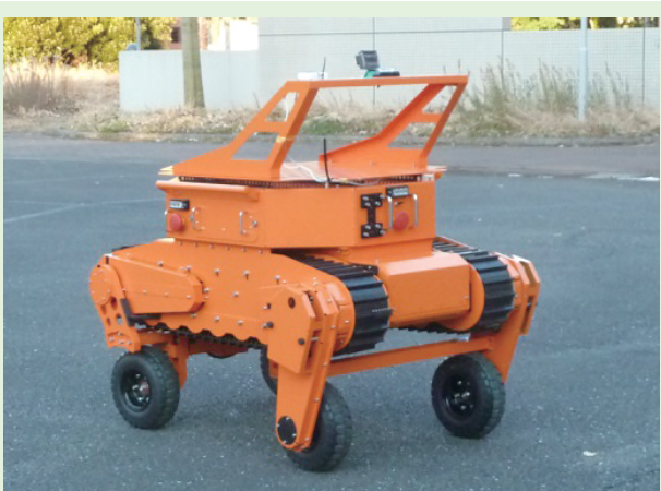
第6-13図 走行型ロボットの走行機構
