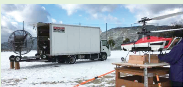
第6-12図 飛行型ロボットの強風検証実験
