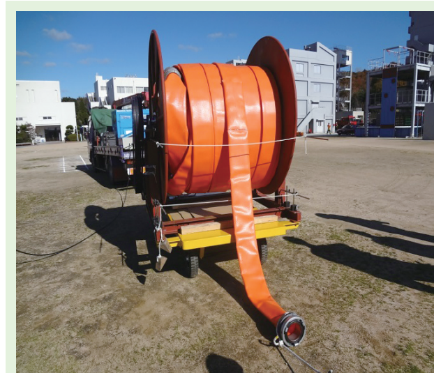
第6-15図 ホース繰り出し機構検証実験
